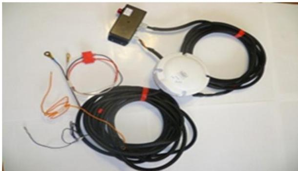
Рис. 1 AT «DMR-iSat» со спутниковым каналом передачи данных Inmarsat IsatM2M
