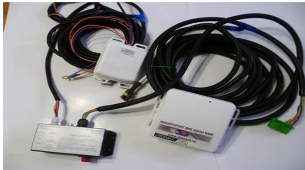
Рис. 2 AT «SL-iSat» с двумя каналами передачи данных GPRS и Inmarsat IsatM2M
