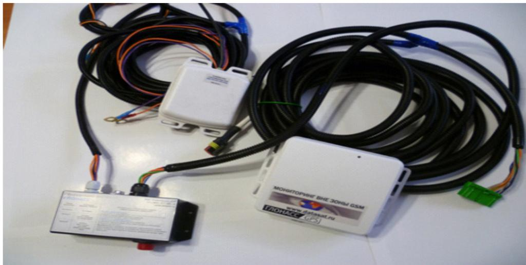
Рис. 2 AT «SL-iSat» с двумя каналами передачи данных GPRS и Inmarsat Isat M2M
